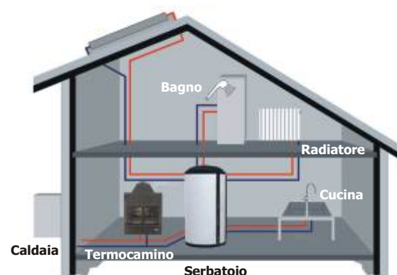
Pannello Solare Termico
